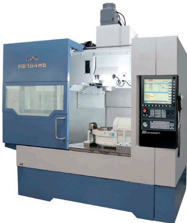
Рис. 4. Вертикально-фрезерный ОЦ КВС МВ 184М5 с отечественной системой ЧПУ «ОЛИМП»
