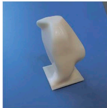
Рис. 5. Деталь «джойстик», обработанная на 5-осевом ОЦ КВС МВ 184М5 с ЧПУ «ОЛИМП»
